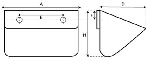
En tôle d'acier extra-forte, emboutie. Le fond et les angles arrondis évitent au contenu de rester dans le godet, même si la matière à élever est humide. A vitesse lente, l'INUSABLE travaille bien tous les grains. Le montage sur la courroie est alors assez espacé. A vitesse rapide, l'INUSABLE travaille non seulement les grains, mais aussi les produits en poudre. Leur montage est plus rapproché.
