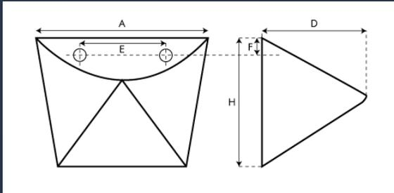
Modèle conique à déversement continu, en forte tôle d'une seule pièce et sans soudure. Ces godets se montent les uns derrière les autres sur la courroie, à se toucher. Le fond angulaire aplati du godet «le RAPIDE» et son angle de projection sont étudiés pour permettre son montage dans des élévateurs classiques. Ils travaillent très bien les produits granuleux secs, le blé et les céréales.
